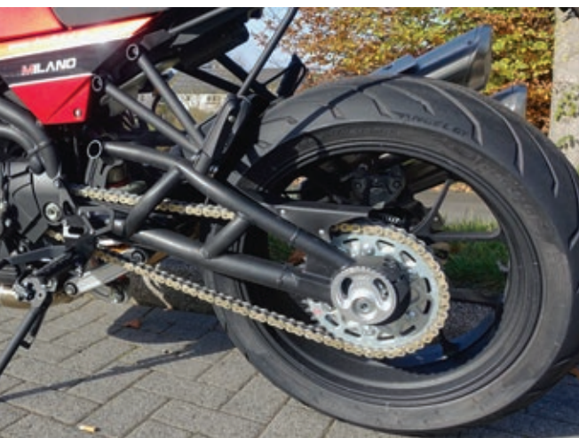
Zum Rahmen passende Gitterrohrschwingen mit großem Exzenter, gefrästem Kettenrad und Schmiederädern.
