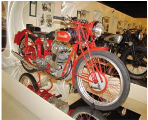
Oben: Benelli 250 4TSS mit nur einem Auspuffrohr. Im Gegensatz zur 220er ist der Zylinder etwas nach vorne geneigt.
