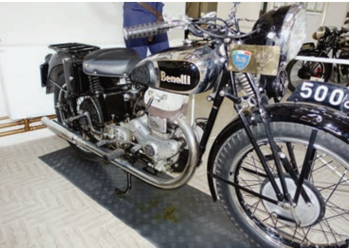
Links: Bei der VL 500 befinden sich die Ventile auf der rechten Seite unter dem viereckigen Motordeckel am Zylinder.
