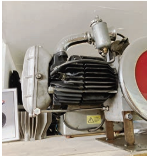
Eine montierte Obensteuerung, also ein geschlossener Ventiltrieb, von Velox für einen Moto Guzzi-Motor.
