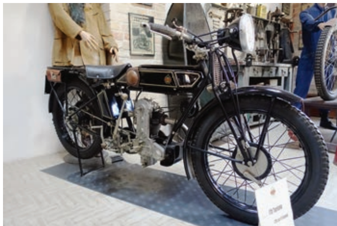
Die 147er-Benelli Sport von 1928 mit zwei Auspuffrohren für einen Zylinder.
