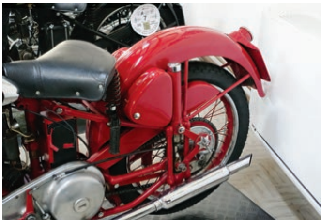
Die Hinterradfederung von Benelli ist ganz anders aufgebaut als die Konstruktion von Moto Guzzi. Hier befinden sich die Federn senkrecht über der Hinterradachse, während sie bei der Moto Guzzi waagrecht unter dem Motor liegen.
