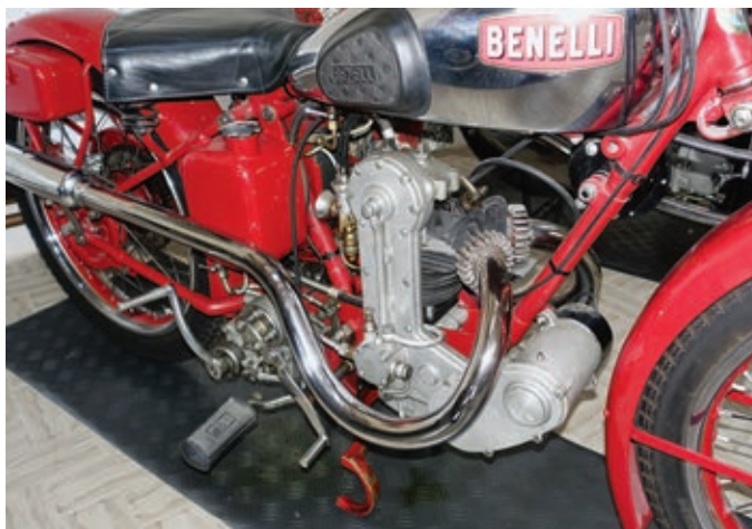
Benelli 220 mit offenliegendem Ventiltrieb. Auch bei dem Viertakter besitzen Motor und Getriebe noch eigene Gehäuse.
