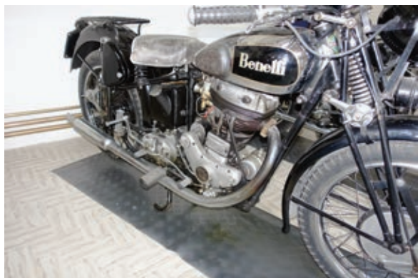
Links: Bei der VL 500 befinden sich die Ventile auf der rechten Seite unter dem viereckigen Motordeckel am Zylinder.
