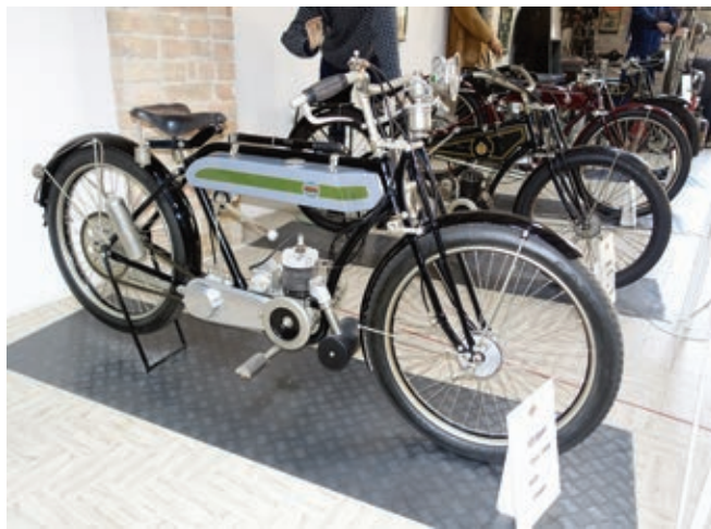
Benelli Sport 125 aus dem Jahr 1925 mit kleinem Zweitaktmotor. Das separate Getriebe befindet sich dicht vor dem Hinterrad.
