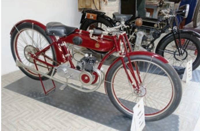
Die 147er-Benelli Sport von 1928 mit zwei Auspuffrohren für einen Zylinder.
