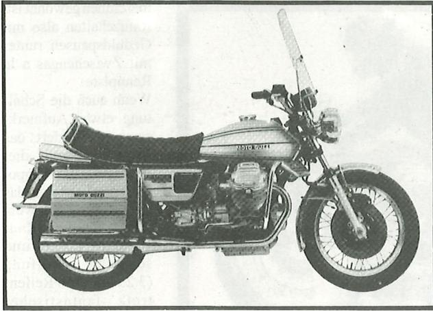
***Mit Automatikgetriebe und Integralbremssystem sollte die V 1000 Convert das Motorradfahren so einfach wie möglich machen. Aber das Automatikkonzept konnte sich nicht durchsetzen. Später wurde das Modell auch unter der Bezeichnung V 1000 G5 mit normalem Fünfganggetriebe angeboten.***
