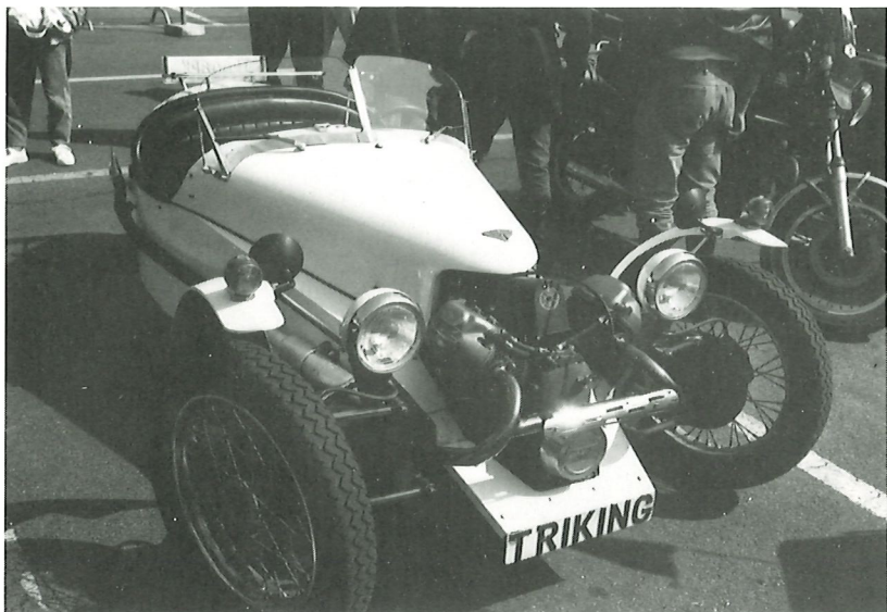
Kein Triking gleicht dem andern. Hier eins mit feststehenden Kotflügeln und verkleideter Ölwanne.
