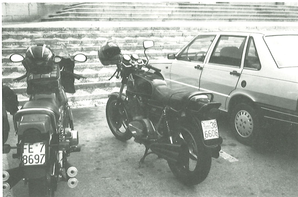
Zwei Laverdas mit interessanten Auspuffanlagen: Die Linke hat vier Schalldämpfer und bei der Rechten sind es sogar sechs Tüten, die die Abgase ins Freie lassen.
