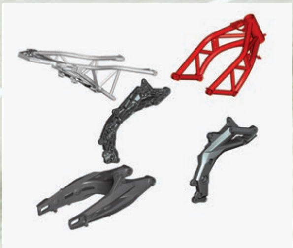
Das Fahrwerk der Dorsoduro ist ein Verbund aus verschiedenen Komponenten. Front- und Heckrahmen sind aus Stahlteilen zusammengeschweißt, aus Aluminium gegossen sind die Seitenteile und die Schwinge.
