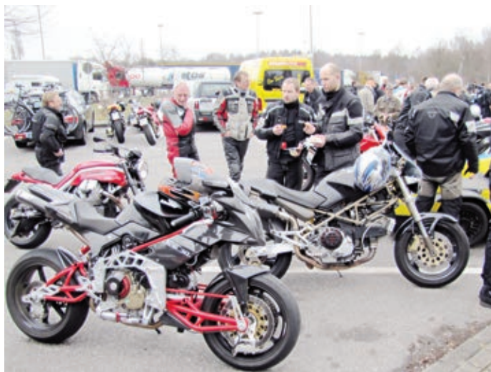
Auch exotische Bikes wie diese Bimota mit Radnabenlenkung bekommt man zu sehen.
