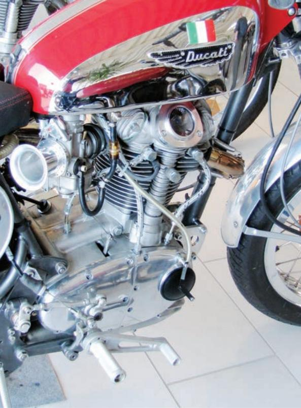
*Tarozzi-Fußrastenanlage mit Verlegung der Schaltung von rechts nach links durch die Schwingenachse.*
