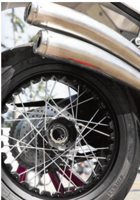
Links: Kineo-Räder mit CNC-gefrästen Naben und Felgen vereinen klassisches Design und moderne Technik.
