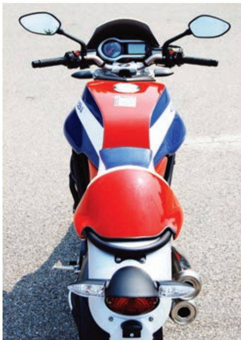
Oben: Der knappe Höcker läßt einen Teil des neuen Heckrahmens erkennen.
