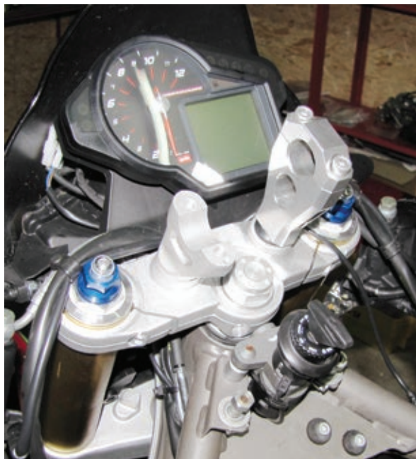
Links der originale, gegossene Lenkerhalter, rechts der gefräste aus der Tuono R.
