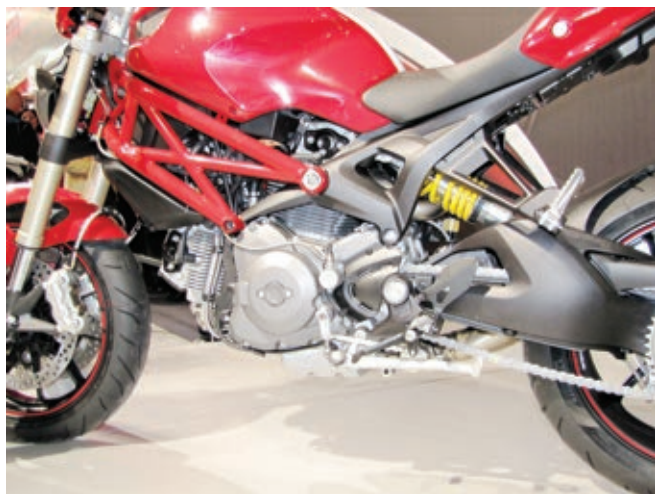
Verbundrahmen aus Gitterrohrkonstruktion und Gußteilen. Das Federbein ist direkt mit Rahmen und Einarmschwinge verschraubt.
