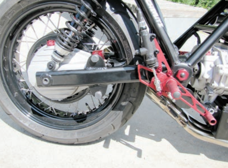
Für die Halterung des Kardans wurden zwei Laschen an die Schwinge geschweißt und ein Halterungsblock gefräst.
