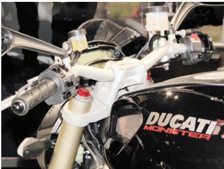
20 Millimeter höhere Lenkerböcke sorgen für eine aufrechtere Sitzposition. Die Gabel ist komplett einstellbar.
