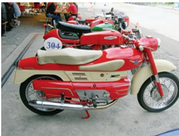
Die Chimera 175/250 war das erste Modell mit dem liegenden Einzylinder-Viertaktmotor. Es wurden nur knapp 300 Exemplare gebaut. Damals war das Design recht futuristisch.
