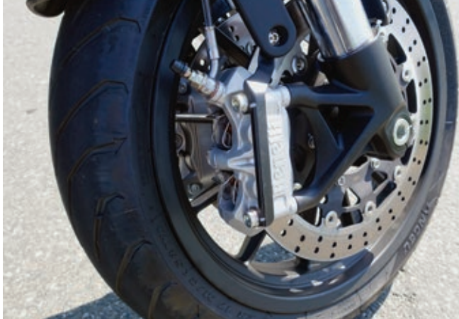
Benelli-Bremszange mit vier einzelnen Belägen. Eine direkte Kopie der renommierten Brembo-Stopper.
