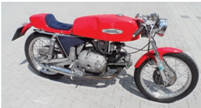
Eine Liegme-Aermacchi 250 mit Kastenschwingen und Exzenter zum Einstellen der Kettenspannung.
