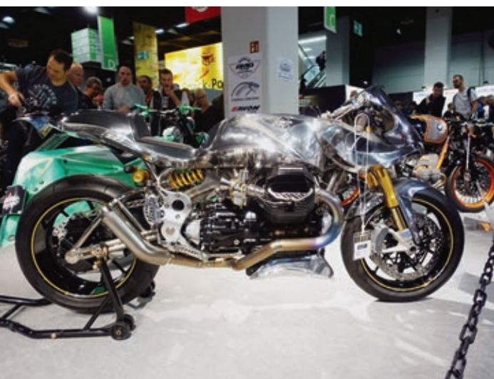
Oben und unten: Eine Moto Guzzi mit Rahmen, Schwinge und vielen anderen Bauteilen aus Titan. Die Maschine bringt lediglich 155 Kilogramm auf die Waage.
