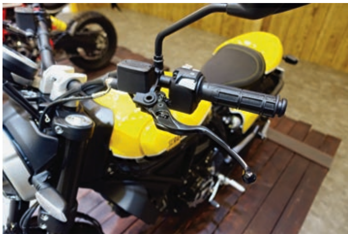
Alle Ducati Scrambler 800 besitzen nun eine hydraulisch betätigte Kupplung, und jetzt lassen sich die Handhebel bzw. deren Entfernung zum Lenker einstellen.
