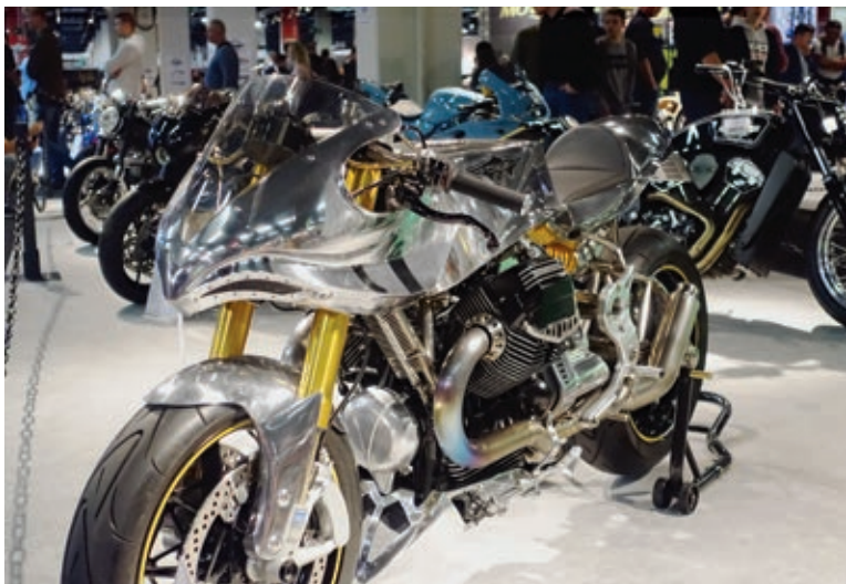
Oben und unten: Eine Moto Guzzi mit Rahmen, Schwinge und vielen anderen Bauteilen aus Titan. Die Maschine bringt lediglich 155 Kilogramm auf die Waage.
