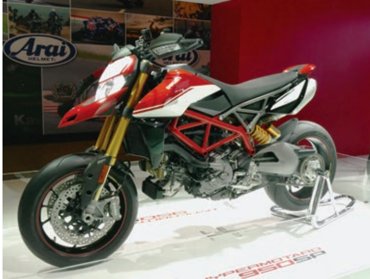
Die zweifarbige Hypermotard 950 SP mit Öhlins-Federelementen und mehr Schräglagefreiheit.
