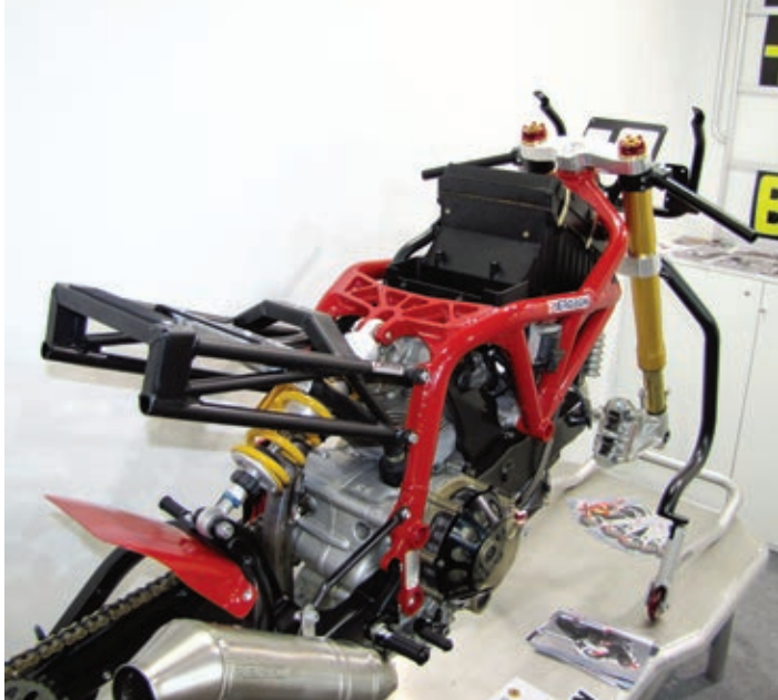
Die Aufnahme für den Stoßdämpfer ist aus dem Vollen gefräst, wie an dieser Pierobon gut zu erkennen ist. Auch der große Luftfilterkasten ist gut zu sehen.
