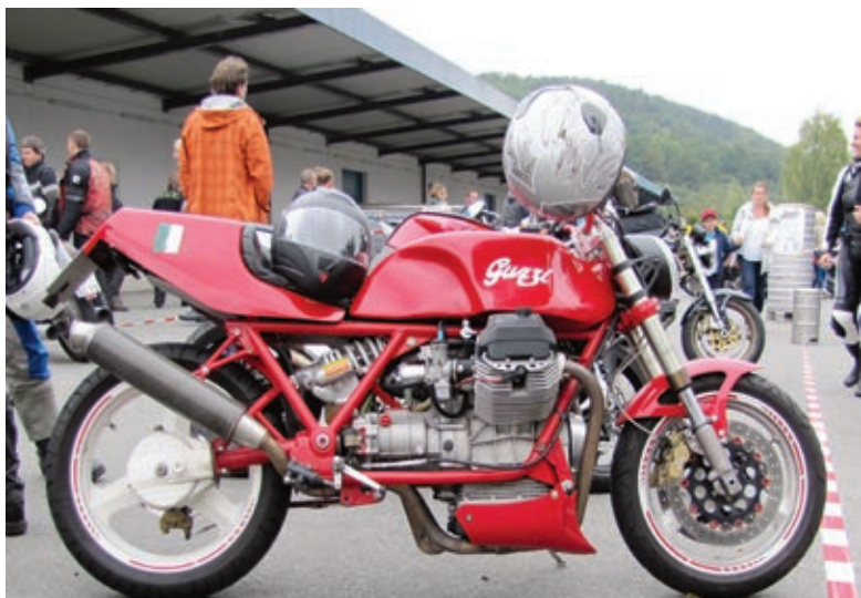
Umfangreich umgebaute Guzzi mit Upside-Down-Gabel, Zentralfederbein und einigem mehr.
