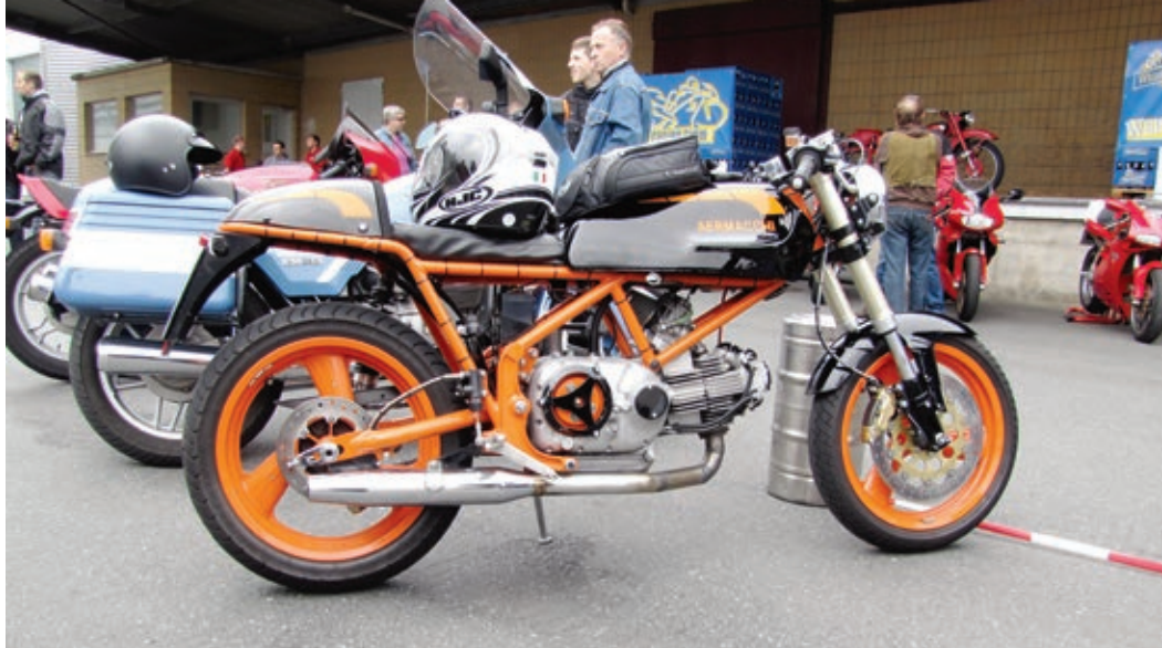
Schöne Aermacchi mit modifiziertem Rahmen und Fahrwerkskomponenten, die vermutlich von einer Aprilia 125 stammen.
