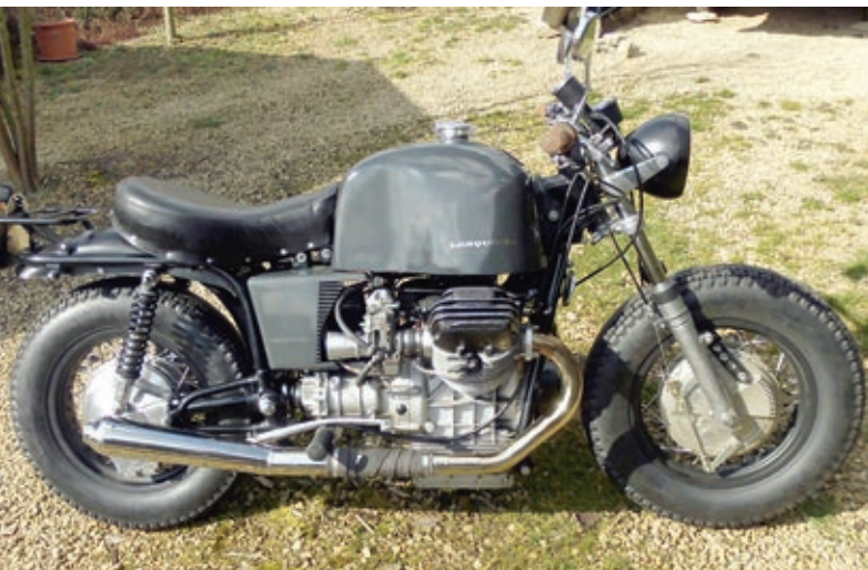
Der große Tank faßt 45 Liter. Die verrippten Ventildeckel stammen von der Firma Blake aus den USA.
