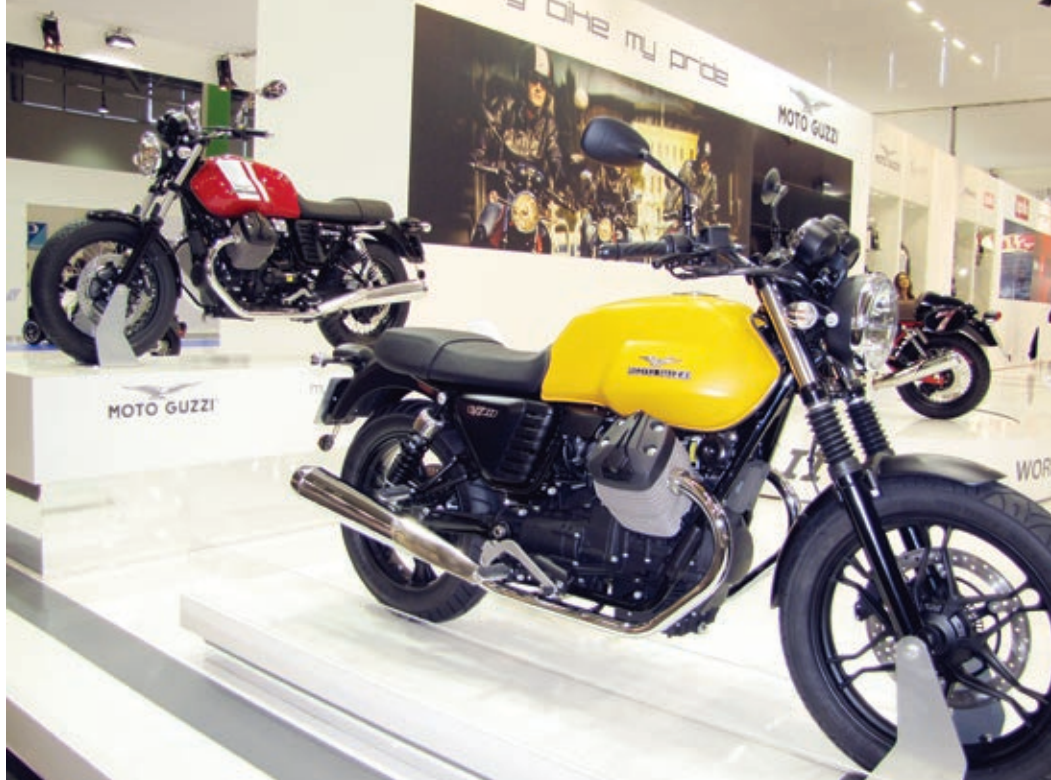
Rechts die V7 II Stone mit leichten Gußrädern für Schlauchlosbereifung. Links die V7 II Special mit klassischen Speichenrädern und Tankdesign im Stil der 750 Sport aus den siebziger Jahren.
