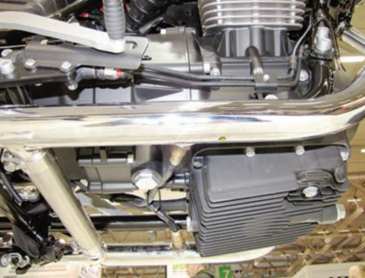
Getriebeablaßschraube mit dahinter positioniertem Filter. Gut zu sehen auch die beiden Lambdasonden.
