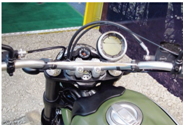
Das runde LCD-Cockpit ist außermittig positioniert. Die in Gummi gelagerte Lenkerhalterung verringert die Vibrationen.
