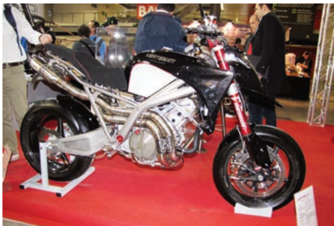
Vertemati: Supermoto mit Titanrahmen und Carbonrädern.
