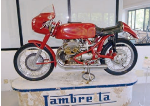
Eines der Highlights im Lambretta-Museum in Segrate ist die 250er-GP-Maschine von 1953 mit V2-Motor, separatem Getriebe und Kardanantrieb.
