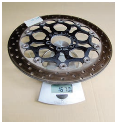
Die Bremsscheibe rechts ist gut 25 Prozent leichter als die linke. Zwei Scheiben sparen 860 Gramm rotierende und ungefederte Massen.
