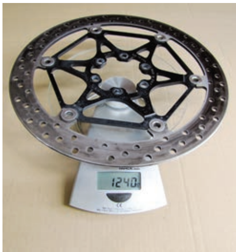
Die Bremsscheibe rechts ist gut 25 Prozent leichter als die linke. Zwei Scheiben sparen 860 Gramm rotierende und ungefederte Massen.
