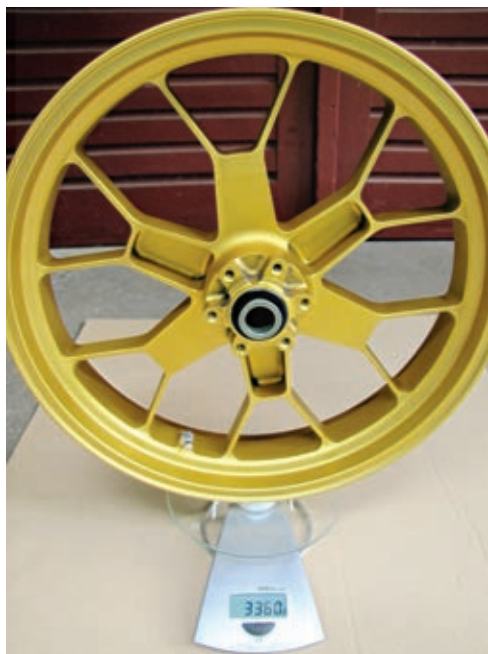
Die Felge wiegt ungefähr so viel wie zwei Bremsscheiben.
