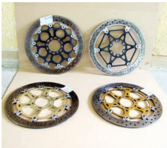
Vier Bremsscheiben von drei verschiedenen Herstellern. Links oben der Brembo-Stopper aus der RSV Mille, daneben die deutlich leichtere Grimeca-Scheibe aus der RSV4 Factory. Unten links Sunstar aus der Tuono und rechts eine jüngere Brembo-Scheibe.
