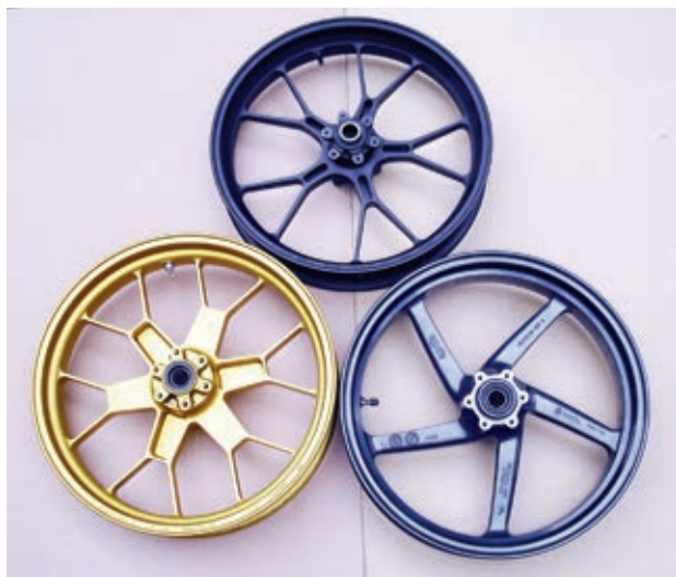
Drei verschiedene Aprilia-Vorderräder. Unten rechts das Fünf-Speichen-Brembo-Rad von der ersten RSV Mille. Links daneben ein OZ-Schmiederad aus dem R-Modell. Oben ist das Rad aus der aktuellen RSV4 Factory.
