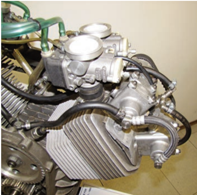
Vier Vergaser in Fallstromanordnung sorgen hier für das Gemisch.
