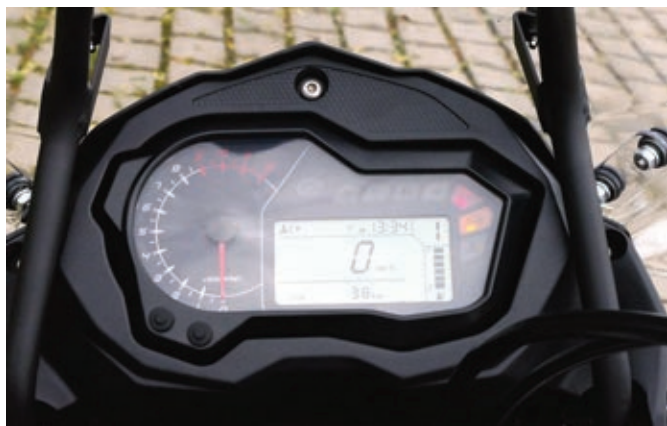
Gut ausgestattetes Cockpit mit Anzeigen für Gang, Tank und Uhr neben Tacho und Drehzahlmesser.
