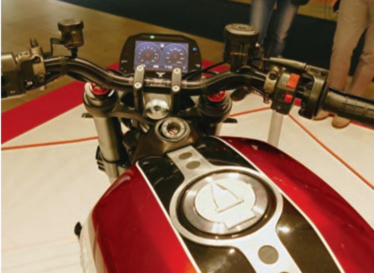
Das TFT-Display kann jetzt auch zwei virtuelle Rundinstrumente darstellen.
