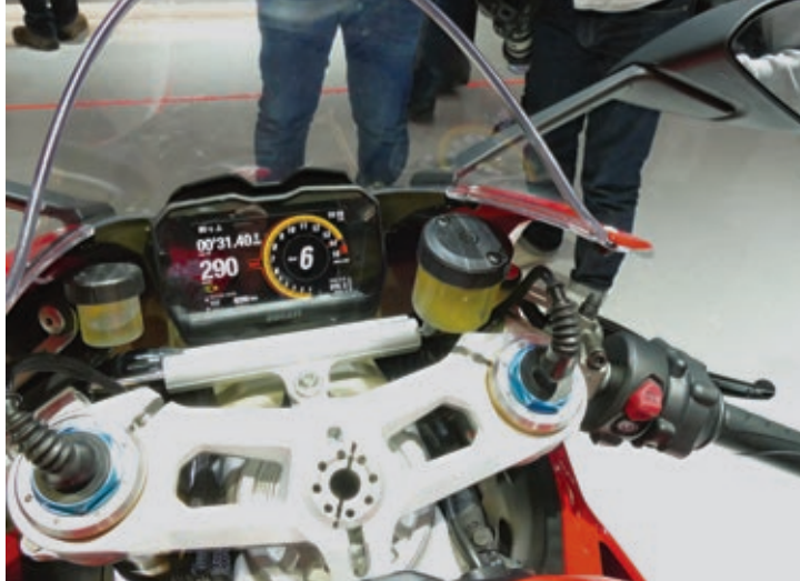
Elektronisches Fahrwerk an der S-Version und ein neues TFT-Cockpit, hier im Race-Modus mit Anzeige der Rundenzeit.
