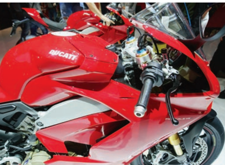
Das Seitenteil der Vollverkleidung deckt auch die Tankflanke ab. Unter der Plastikabdeckung vor dem Tank befindet sich die Elektrik samt Batterie.
