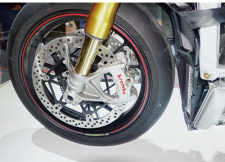
Neue Bremssättel mit der Bezeichnung Stylema von Brembo sind nochmal 70 Gramm leichter und verfügen über eine verbesserte Durchlüftung.
