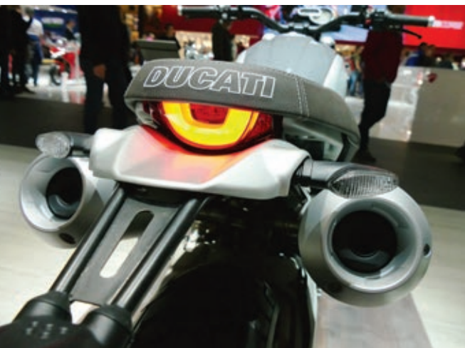
Unter der Sitzbank verstecktes LED-Rücklicht mit Diffusor über den LEDs.
