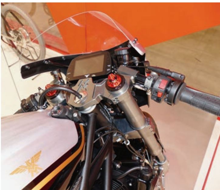
Gefräste Gabelbrücken an der Ti22. In die obere ist das Moto Morini-Logo eingearbeitet.
