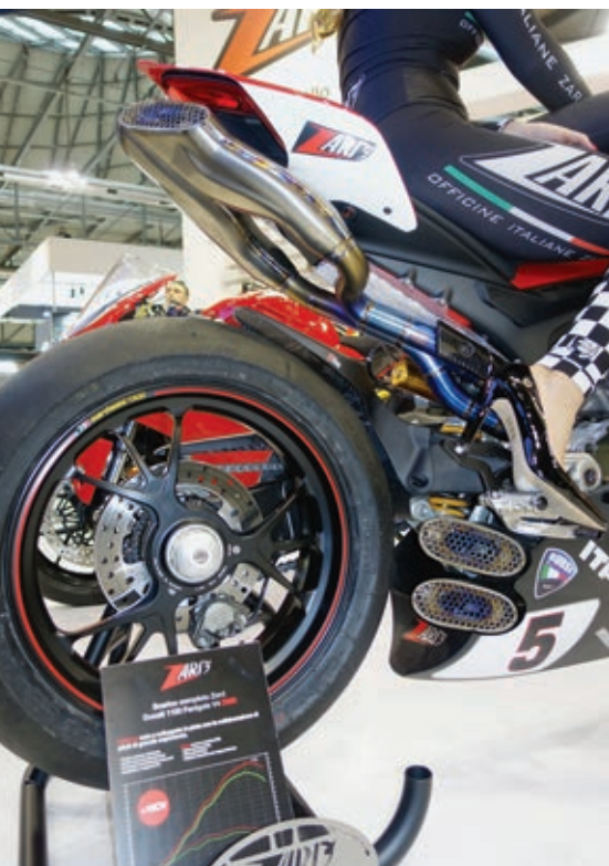
Oben: Termignoni-Racinganlage für die Ducati V4 mit 1.100 Kubikzentimetern, so wie sie in der italienischen Meisterschaft gefahren wurde.
