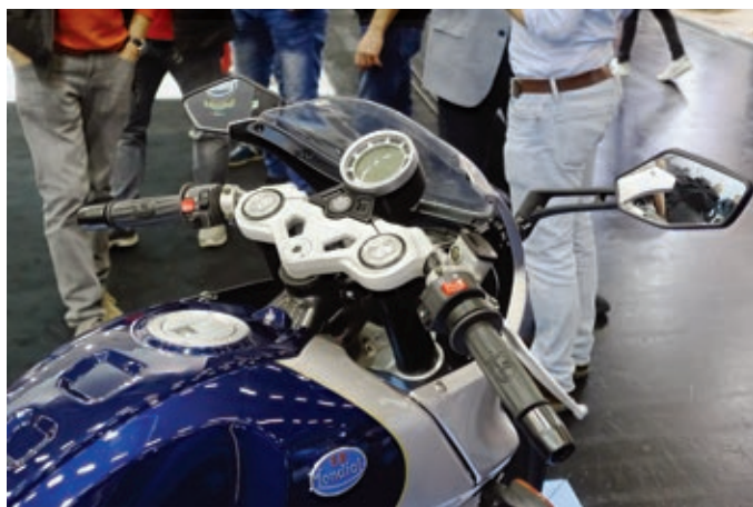
Jetzt mit starren Stummeln, die in die obere Gabelbrücke integriert sind.
