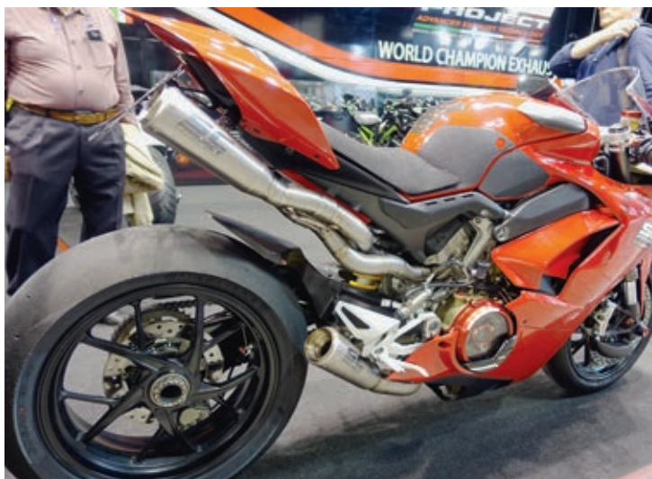
Ein Racingauspuff von der italienischen Firma SC-Project für die Ducati Panigale V4 und V4 S hat zwei kleine Schalldämpfer auf der rechten Seite.
