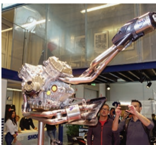
Oben: Termignoni-Racinganlage für die Ducati V4 mit 1.100 Kubikzentimetern, so wie sie in der italienischen Meisterschaft gefahren wurde.
