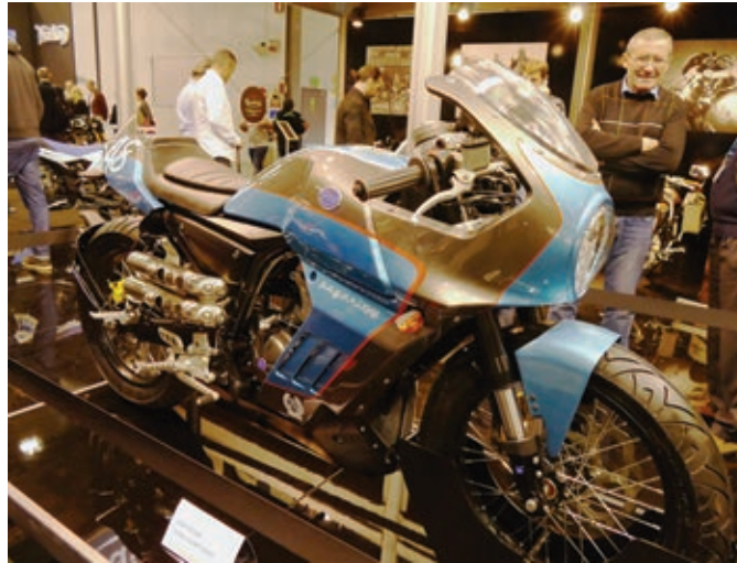
Der erste Prototyp: Die Verkleidung schmiegt sich eng an die Maschine an und geht in den Tank über.
