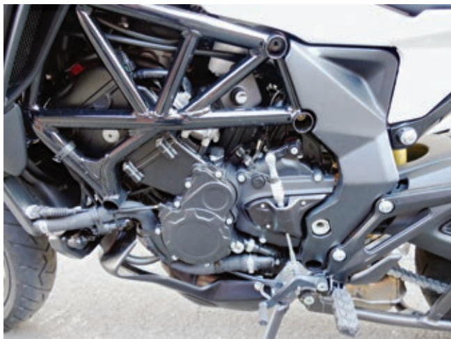
Der Dreizylindermotor ist im schwarzen Gitterrohrrahmen weit nach vorne geneigt.
