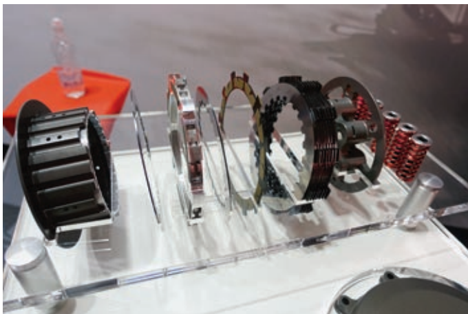
Eine Rekluse-Kupplung, wie sie für andere Motorräder erhältlich ist.
