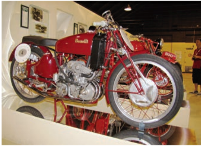
Vier Zylinder mit Kompressor: Benelli 250 von 1942, ein Unikat.
