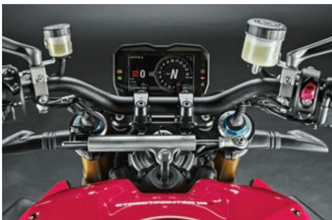
Die Ducati Streetfighter V4 aus der Sicht des Fahrers: Ein großes TFT-Display eingerahmt von zwei Plastikausgleichsbehältern.
