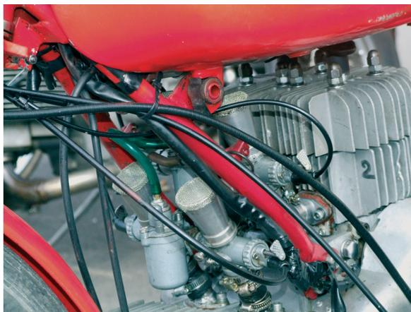
*Ein Gewirr von Bowdenzügen und Benzinschläuchen führt zu den vier Vergasern. Zwei Vergaser in Fallstromanordnung teilen sich jeweils eine Schwimmerkammer. Die Ansaugwege der vorderen Zylinder verlaufen gerade, während die der hinteren Zylinder abgewinkelt sind.*
