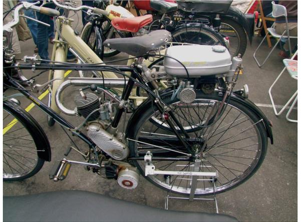
*Viele Hebel, Leitungen und Bowdenzugverteiler sind notwendig, um alle drei Motörchen einsetzen zu können. Der Gasbowdenzug führt zum Beispiel zu einem Verteiler, der hinter dem Lenkkopf auf dem Querrohr sitzt. Von dort werden die drei Vergaser angesteuert.*
