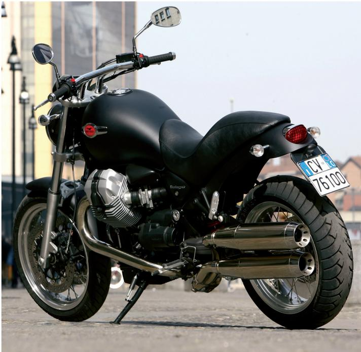
*Bei der Moto Guzzi Bellagio befinden sich beide Schalldämpfer auf der linken Fahrzeugseite.*
