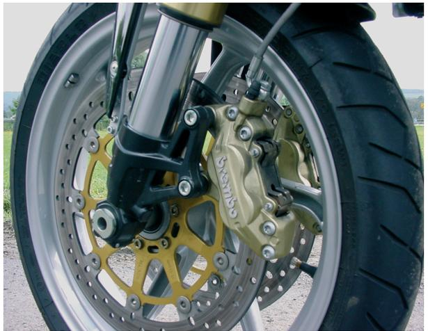
**Italienischer Cocktail: Die Felgen sowie die Bremsanlage stammen von Brembo, und die verstellbare Gabel mit dem Durchmesser von 50 Millimetern liefert Marzocchi.**
