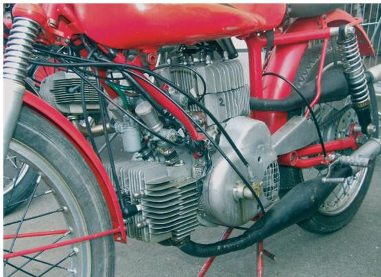
Auch wenn der Umbau einen interessanten Eindruck macht, ist es fraglich, ob er thermisch Standfest ist. Die Kühlrippen der stehenden Zylinder befinden sich in einem Winkel von 90 Grad zum kühlenden Fahrtwind. Ausgerechnet die heiße Auspuffseite befindet sich im Windschatten der Zylinder, anstatt dem kühlenden Fahrtwind zugewandt zu sein. Außerdem behindern die Vergaser den Luftstrom zu den stehenden Zylindern.
