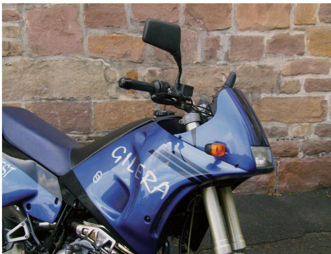
*Die Cockpitverkleidung und die Seitenverkleidungen über dem Kunststoffank sind miteinander verschraubt und bilden eine Einheit. Die Upside-Down-Gabel war damals noch etwas besonderes.*
