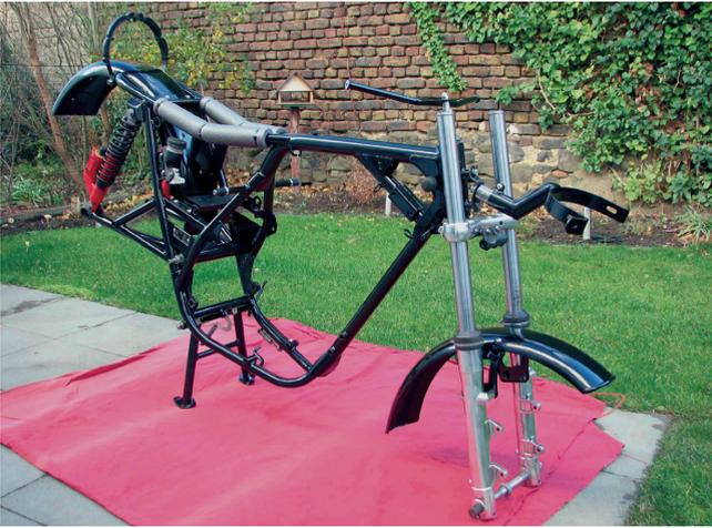
***Das Fahrgestell mit pulverbeschichtetem Rahmen wartet auf die weiteren Montagearbeiten.***
