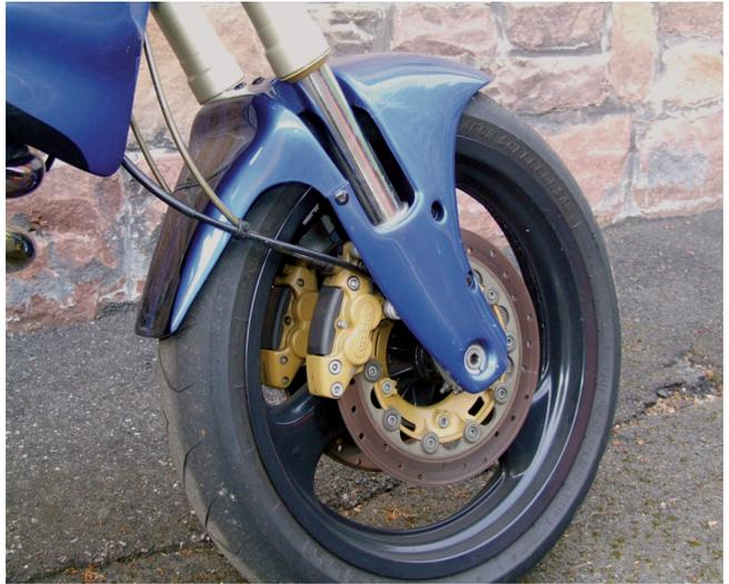
**Zwei Graugußbremsscheiben und Vierkolbenbremssättel von Grimeca sorgen für eine ordentliche Verzögerung.**
