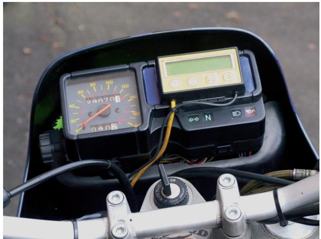
*Temperaturanzeige und Drehzahlmesser sind defekt. Als Provisorium zeigt ersteinmal ein Zusatzinstrument von My Chron Drehzahlen und Temperatur an.*
