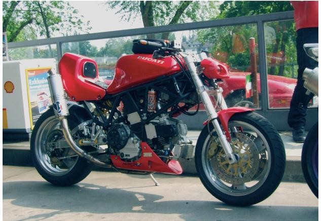
***Streetfighterumbau mit fast senkrecht montierten Schalldämpfern.***
