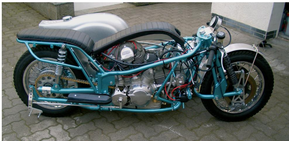
*Auf den ersten Blick ist dieses Gefährt eine ungewöhnliche Konstruktion. Solche Gespanne werden Kneeler (nach dem englischen Wort für Knie) genannt, weil der Fahrer nicht oben auf der Maschine sitzt, sondern eher kniet, um so einen möglichst tiefen Schwerpunkt zu erzielen. Die Fußrasten befinden sich noch hinter der Hinterradachse.*
