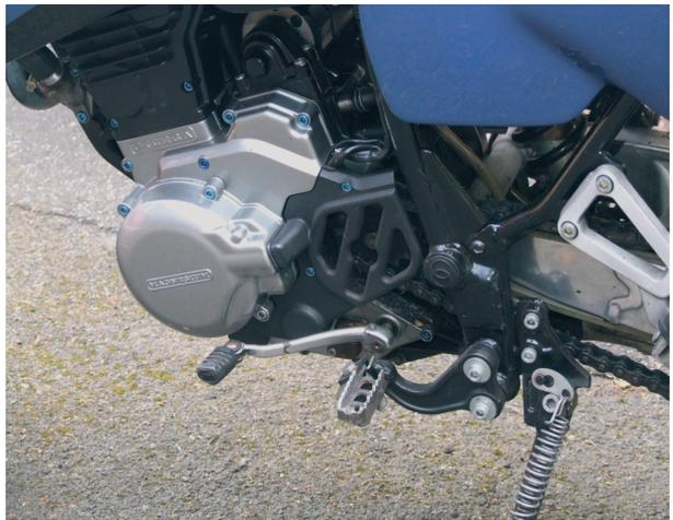
*Bei den Fußrasten fehlen die Gummis. Die Motorseitendeckel aus Magnesium erhielten einen silbernen Lack.*
