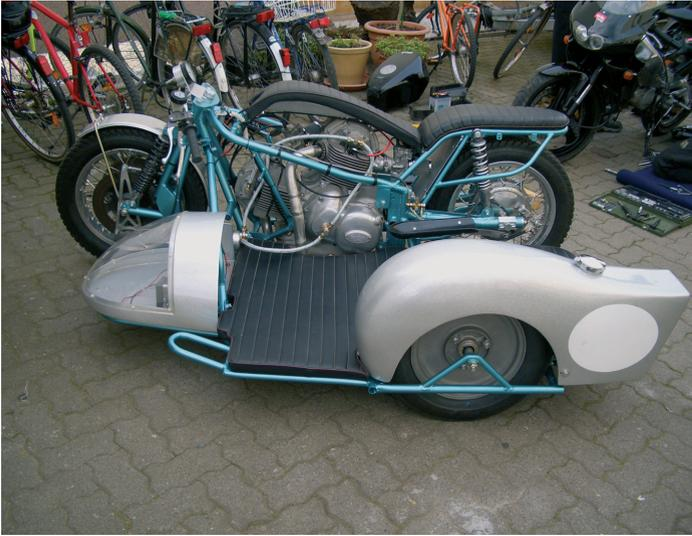
***Der Benzintank befindet sich im Kotflügel des Seitenwagens.
