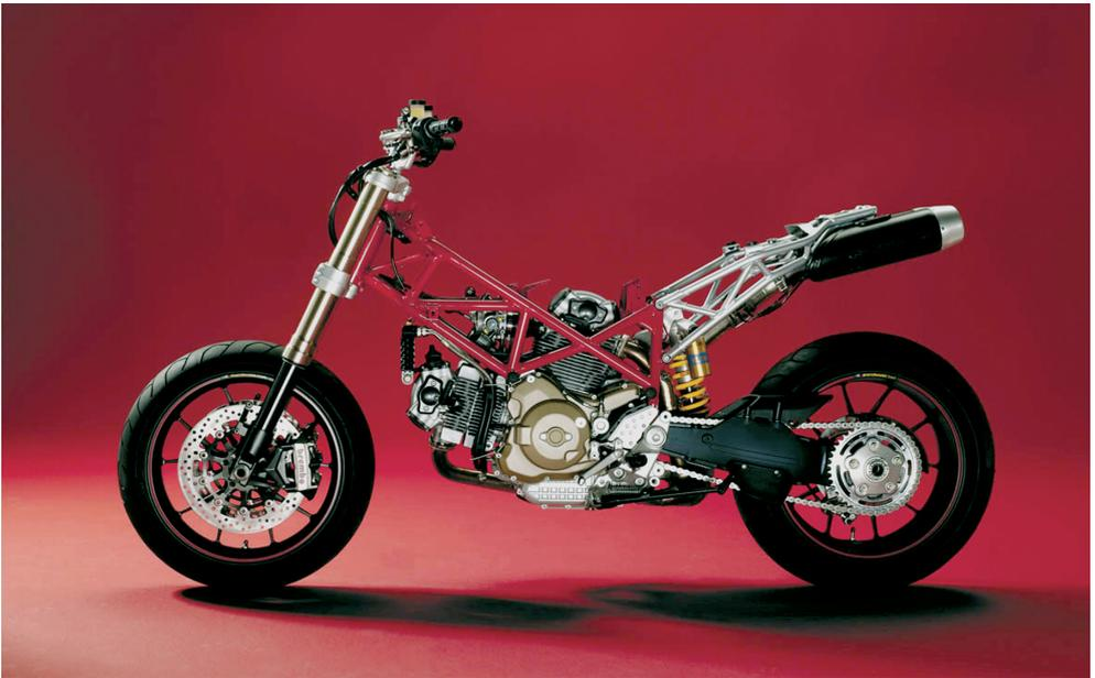
*Ohne die Plastikteile sieht man, wie puristisch die Hypermotard aufgebaut ist. Anders als die Multistrada verfügt die Supermoto über ein geschraubtes Rahmenheck aus Aluminium.*
