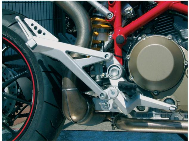
**Die Fuhrastenanlage ist im Gegensatz zur ersten Multistrada so gefertigt, daß man die Sozustrastenanlage leicht demontieren kann.**
