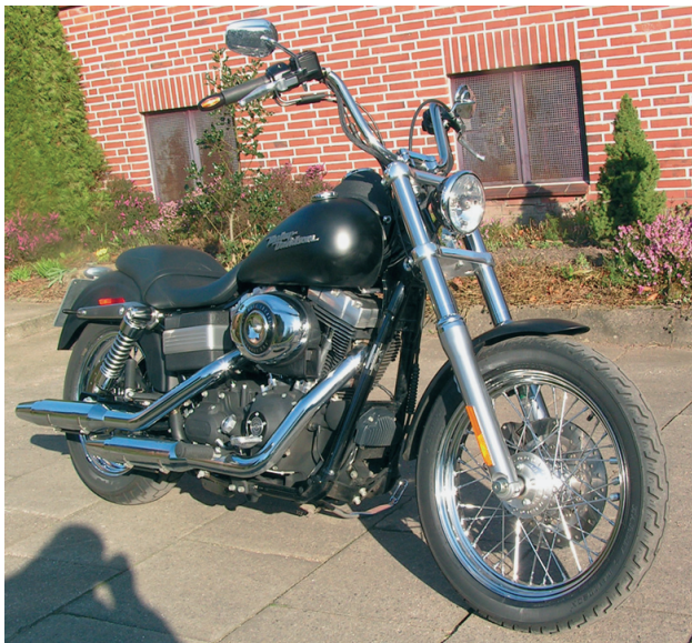
Das ist der Trennungsgrund: 1.600 Kubikzentimeter, 76 PS und 135 Newtonmeter bei ca. 3.000 U/min.
