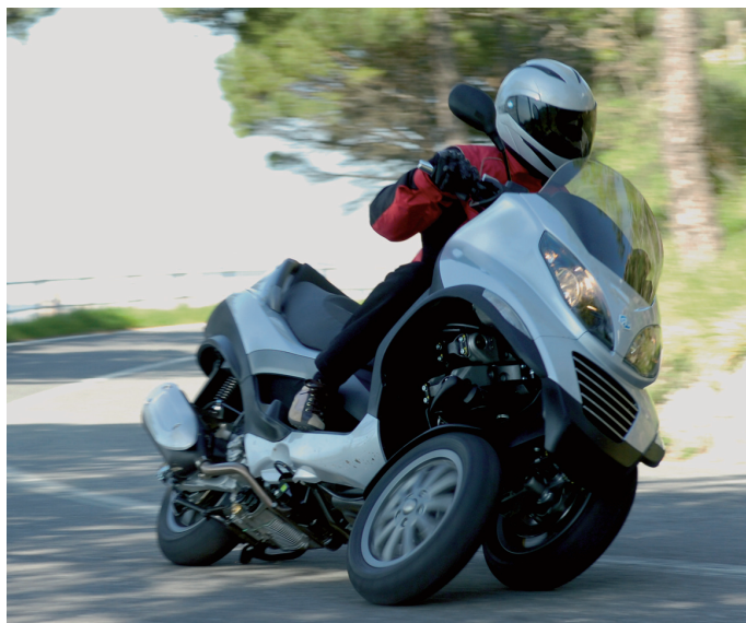
Es sind Schräglagen bis zu 40 Grad möglich.
