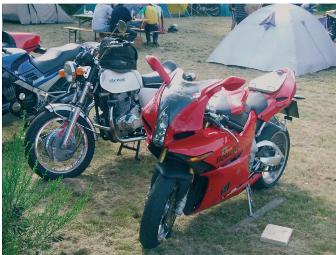
Zweimal Benelli Tornado: Links eine 650er mit zwei Zylindern aus den 70er Jahren und rechts eine moderne 900er mit drei Zylindern. Dort dient ein Aluriffelblech anstatt des Soziuspolsters der Gepäckbeförderung.
