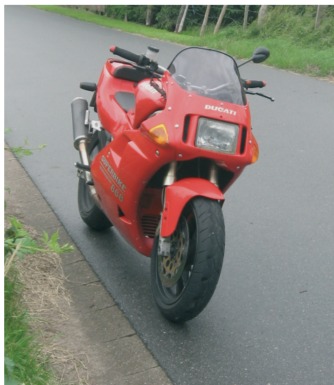
Rechts und links neben dem rechteckigen Scheinwerfer befinden sich die Lufteinlässe für die Airbox.
