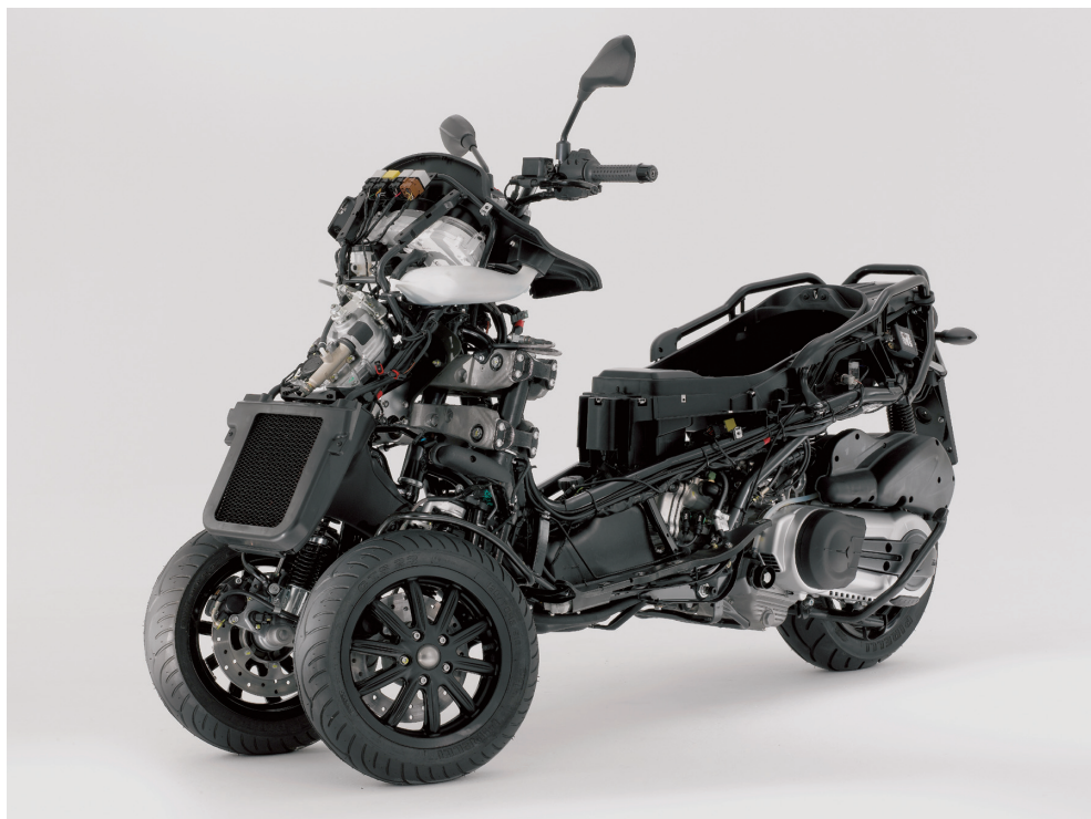
So schaut das Fahrwerk des Gilera Fuoco aus. Das Heck entspricht einem konventionellen Roller.
