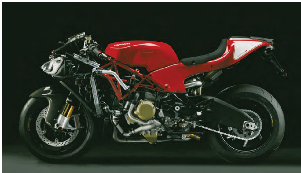
Der V4-Motor mit knapp einem Liter Hubraum baut sehr kompakt.
