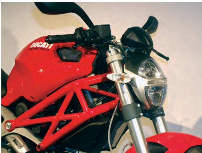
*Der Scheinwerfer sieht etwas futuristisch aus. In den Tankattrappen befinden sich die Ansaugöffnungen des Luftfilterkastens.*
