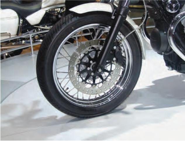
*Die Bremszange und der Innenstern der Bremsscheibe sind in dezentem Schwarz lackiert. Das Vorderrad hat einen Durchmesser von 18 Zoll.*
