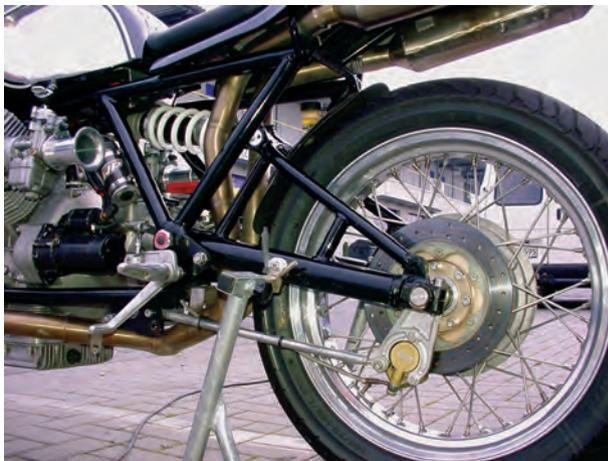
*Die Hinterradfederung ist von zwei konventionellen Hinterradstoßdämpfern auf ein Zentralfederbein umgebaut. Die beiden Auspuffkrümmer vereinen sich unter dem Getriebe, teilen sich wieder und schmiegen sich rechts und links am Federbein vorbei zu den Schalldämpfern hin. Die Federbeinaufnahme in der Schwinge ist exzentrisch verstellbar.*
