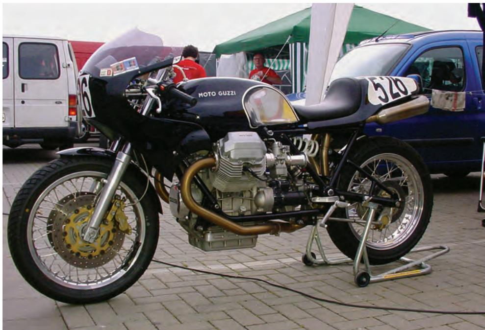
*Schöne Guzzi mit Vierkolben-Bremsanlage und Zentralfederbein.*
