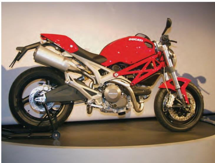
***Der Gitterrohrrahmen reicht nun nur noch vom Lenkkopf bis zum Motor. Erstmals fungieren bei Ducati Alugußteile als Heckrahmen.***
