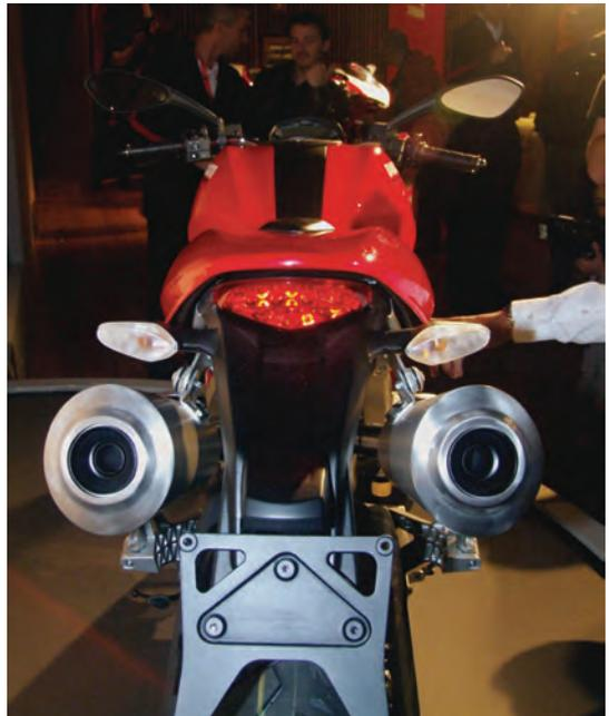
*Auf jeder Fahrzeugseite befindet sich ein hochgelegter Schalldämpfer.*
