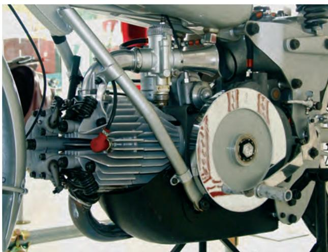
*Die erste Version der Gambalunga verfügte über einen recht langen Hub, um dadurch die Kurbelwellenlager zu entlasten. Daher stammt auch der Name der Maschine, die übersetzt „langes Bein“ oder auch „Langhuber“ bedeutet. Später verwendete Guzzi einen Motor mit kürzerem Hub, um höhere Drehzahlen zu ermöglichen.*
