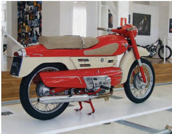
*Viele haben dieses Vehikel damals vermutlich als einen Zwitter zwischen Motorrad und Motorroller betrachtet. Revelli de Beaumont entwarf das Design der Maschine. Der Motor mit einem liegenden Zylinder ist so verkleidet, daß man nur den Kopf und die Ölwanne sehen kann. Die Zweifarbenlackierung war damals ein Zeichen für Eleganz, und die Chimera hob sich deutlich von anderen Motorrädern ab.*
