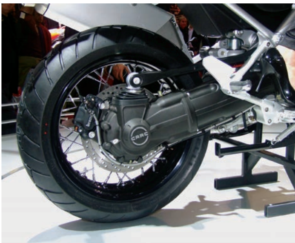
Rechts: Bei fast allen großen Modellen verwendet Moto Guzzi mittlerweile eine Einarmschwinge mit Momentabstützung.
