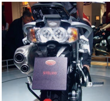
Klarglasrücklicht mit integrierten Blinkern an der Guzzi, dazu zwei unterschiedlich große Auspufföffnungen.
