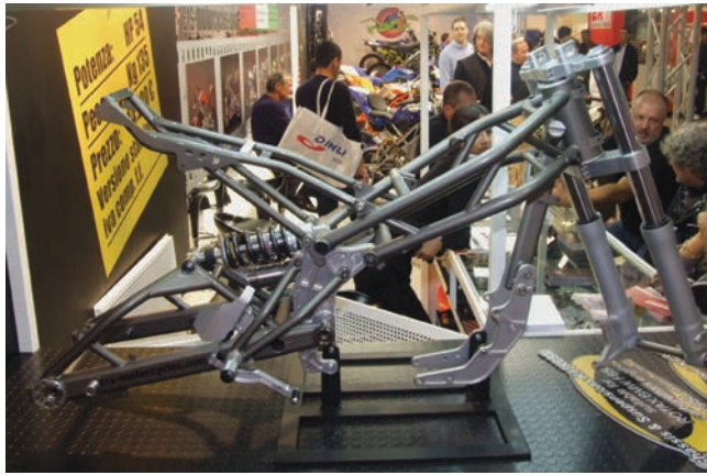
Neu im Programm ist ein Rahmenkit für den Vergasermotor der BMW F 650. Etwas mehr als 5.000 Euro muß man für diesen Satz einplanen.
