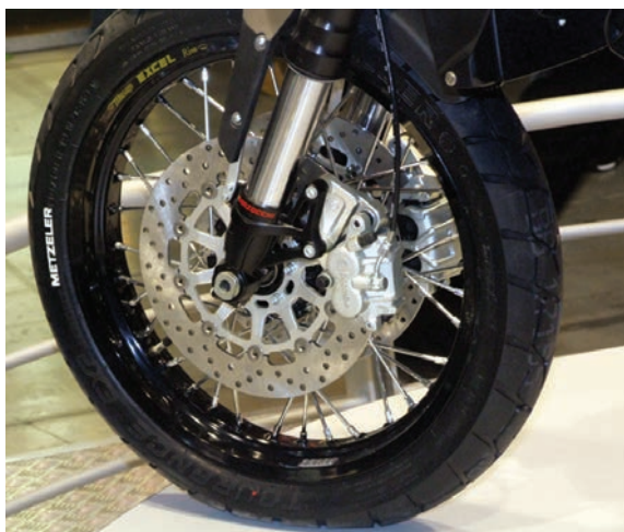
Zweikolben-Schwimmsättel verzögern die Granpasso 1200. An der Gabel ist nichts einstellbar.
