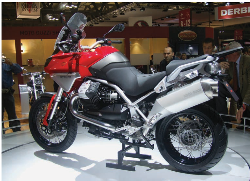
Bei der Guzzi Stelvio 1200 ist der Fahrersitz in der Höhe verstellbar. Der große Schalldämpfer dominiert die linke Fahrzeugseite.
