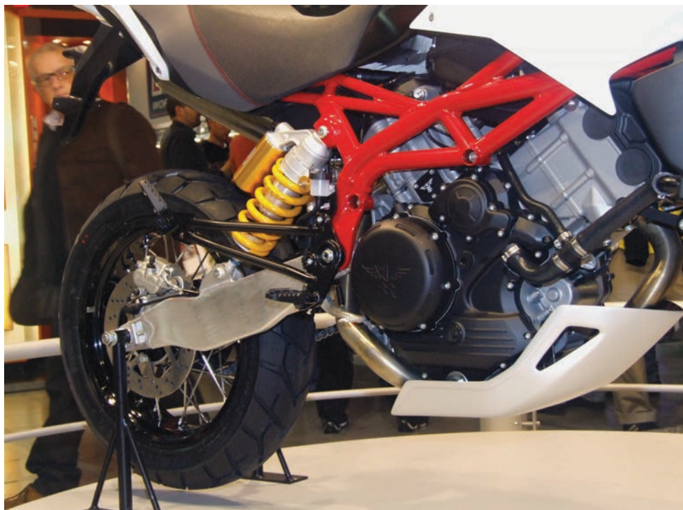
Bei der Morini ist der V2-Motor von unten in den Gitterrohrrahmen eingehängt. Eine Zweiarm-Aluminiumschwinge hält das Hinterrad, und der Stoß- dämpfer befindet sich auf der rechten Fahrzeugseite.
