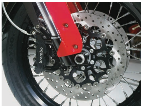
Unten: 320 Millimeter große Bremsscheiben und Vierkolbenbremssättel an der Stelvio.
