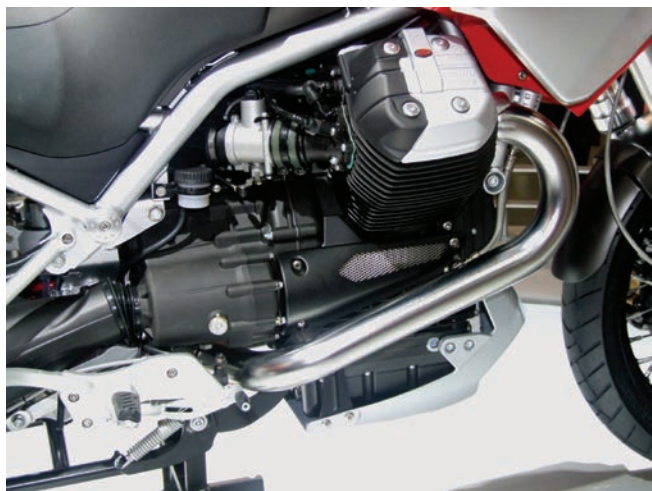
Oben: Typische Moto Guzzi-Bauweise. V-Motor mit angeflanschem Getriebe.
