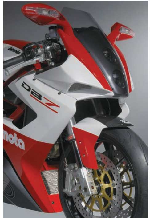
Zwei runde Scheinwerfer übereinander und LED-Blinker in den Spiegeln sorgen für die Beleuchtung vorne. Die Handhebel fräst Bimota selbst.
