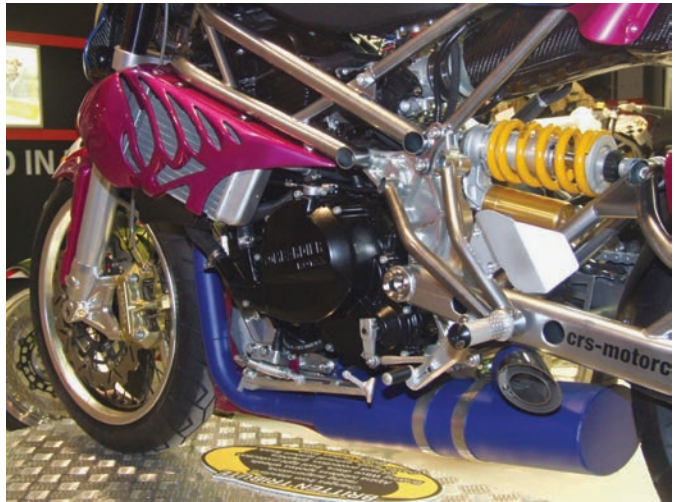
Der Schalldämpfer befindet sich unter dem Motor. Die Kühler sind rechts und links neben dem Zylinder platziert.
