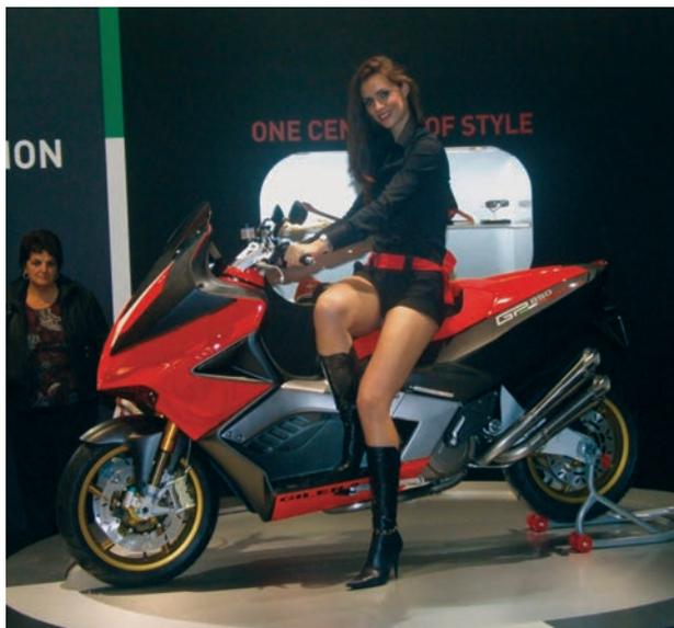
*Gilera Prototyp: Ein Roller mit Öhlins-Gabel und radial verschraubten Bremssätteln vorne.*
