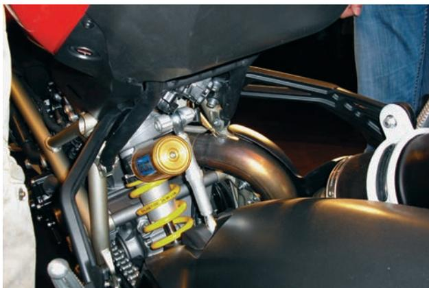
*Oben: Die Hinterradfederung wurde von dem Superbike 1098 übernommen. Die Streetfighter S verfügt über ein Öhlins-Federbein und eine Höhenverstellung.*
