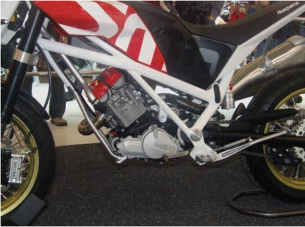
**Der 450er-Motor baut unheimlich kompakt. Die Wasserleitungen führen zum Kühler in der rahmenfesten Cockpitverkleidung. Die Schwingenlagerung und die Getriebeausgangswelle befinden sich in einer Flucht.**
