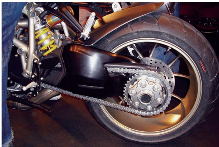
***Um Wheelies zu verhindern, verlängerten die Ingenieure die Einarmschwinge um 35 Millimeter. Die Streetfighter ist eine der wenigen Ducatis mit einem serienmäßigen Innenkotflügel am Hinterrad. Auch bei dem teureren S-Modell ist dieser aus Plastik gefertigt.***
