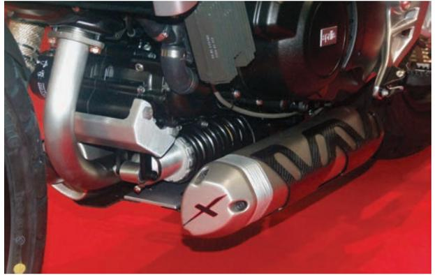
*Oben: Die Auspuffanlage des vorderen Zylinders umschlingt förmlich das unter dem Motor liegende Federbein. Das würde sich im Straßenbetrieb sicherlich zu sehr aufheizen.*
