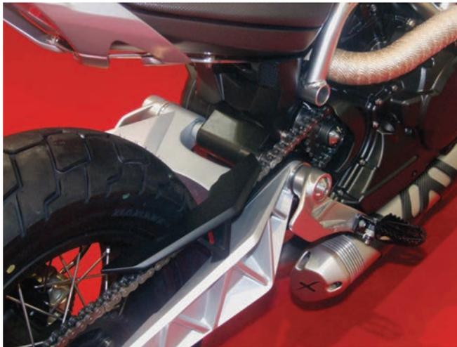
*Links: Die breite Aluminiumschwinge ist im Motorblock gelagert. Der Krümmer ist zum Hitzeschutz umwickelt.*
