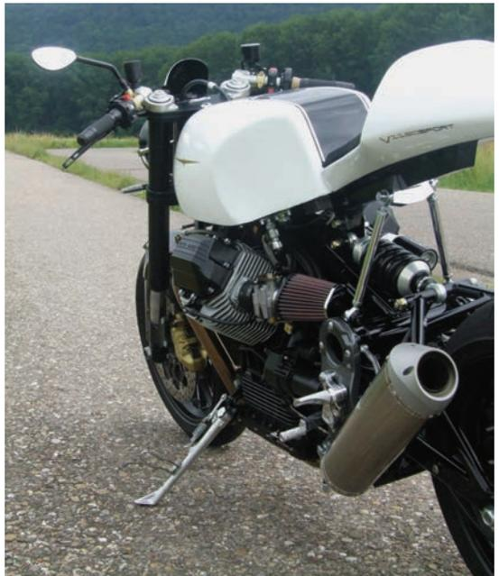
Der Heckrahmen aus einem U-Profil orientiert sich am Design des Zentralrohres und weist schräg nach hinten. Nur zwei filigrane Aluminiumstreben stützen ihn gegen das Querrohr des Rahmens ab. Spielfreie Uni-ballgelenke stellen die Verbindung her und erlauben kleine Anpassungen. Innerhalb des Hecks verbirgt sich ein Teil der sauber verlegten Bordelektrik.
