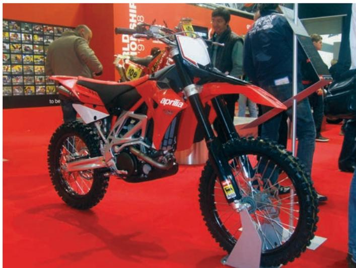
*Aprilia MXV 450 - die einzige mehrzylindrige Moto-Cross-Maschine. Neu sind die Rahmenseitenplatten und die Kastenschwinge, welche auch die Enduro RXV für 2009 erhält.*
